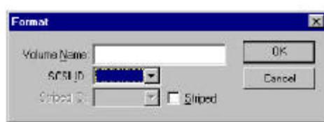
3. Dischi formattati o stripizzati in coppia vengono chiamati "Volumi". Scrivete un nome per il volume nel campo "Volume Name". Ai Volumi si possono dare nomi lunghi fino a 31 caratteri (viene utilizzato l'abituale filename di Windows).
